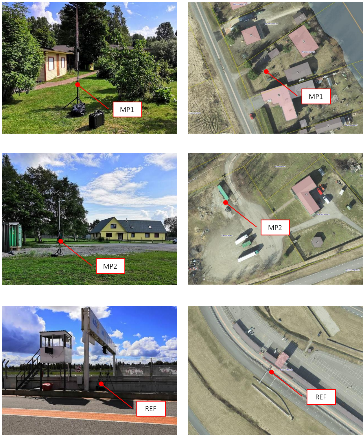
Joonis 2. Ülevaade müra mõõtmiste asukohast ja mõõtmispunktide paigaldusskeem
